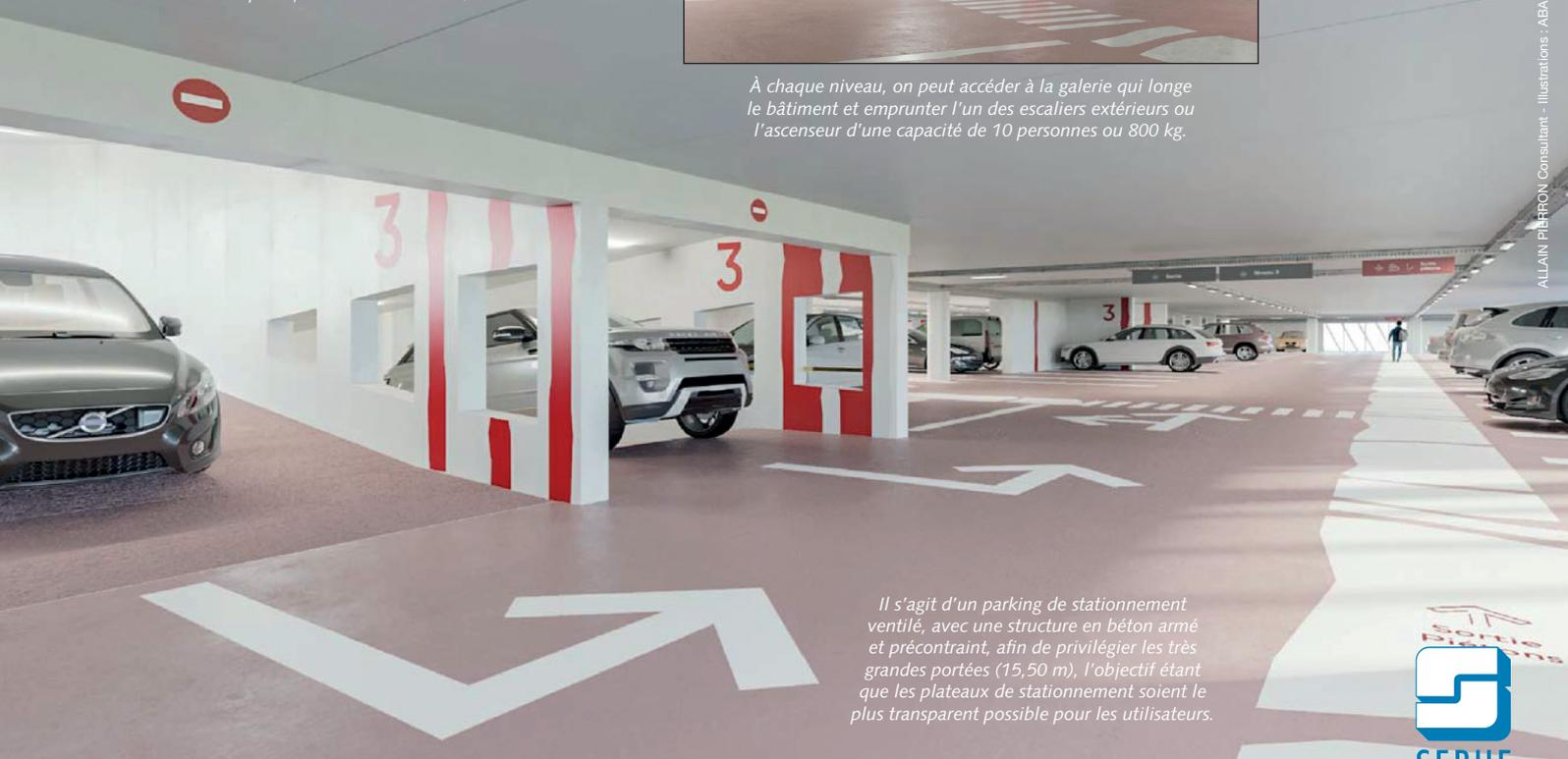
Il s'agit d'un parking de stationnement ventilé, avec une structure en béton armé et précontraint, afin de privilégier les très grandes portées (15,50 m), l'objectif étant que les plateaux de stationnement soient le plus transparent possible pour les utilisateurs.
